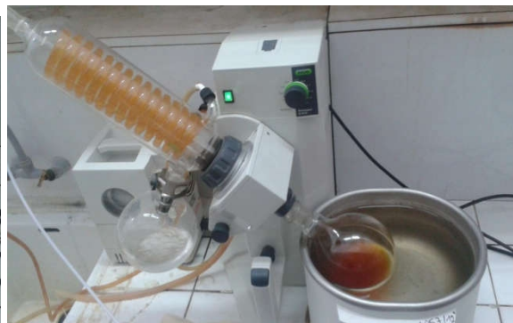
Figure15 : Filtration de l'extrait par Rotavapeur de l'espèce Lepidum Sativum .
